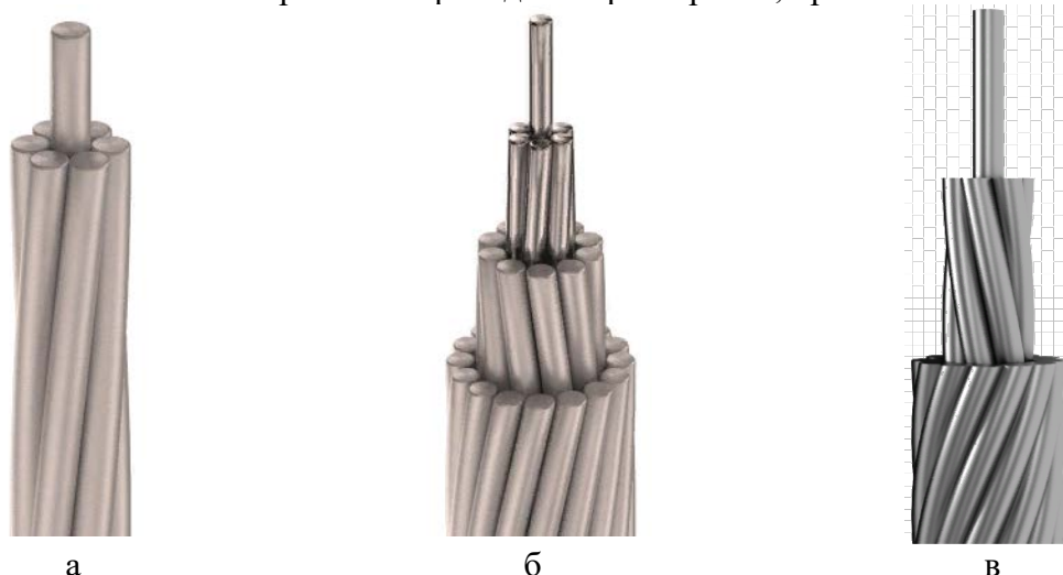
Рис. 1. Изображения проводов и грозотросов: а – провод А-70; б – провод АС – 120/19; грозотрос ГТК -50
