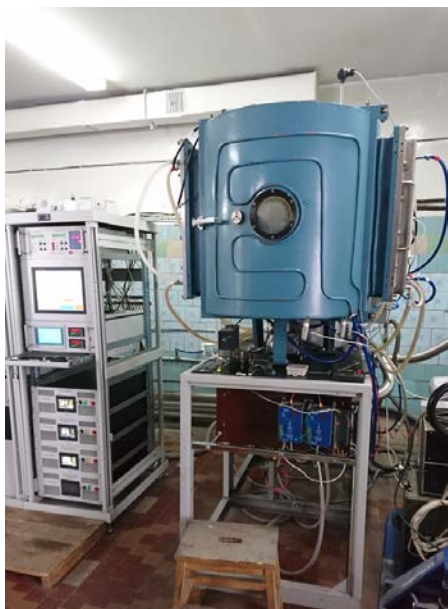
Рис. 3. Общий вид установки ННВ-6,6 И4 УХЛ4, модернизированной под магнетронное распыление
