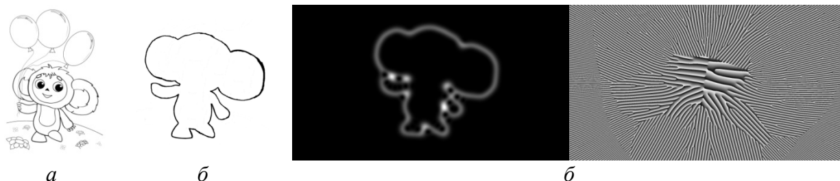
Рис. 5. Исходное изображение (а), выделенный контур (б), рассчитанные распределения интенсивности и фазы (слева и справа соответственно) спирального пучка в форме заданной кривой (в)
