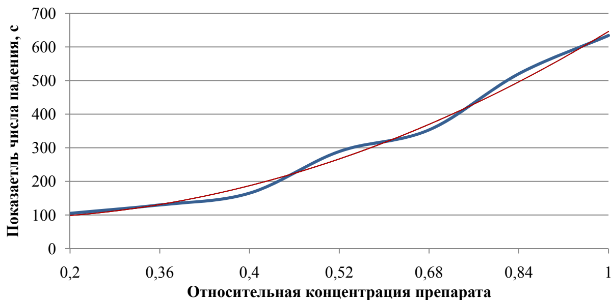
Рис. 2. Ингибирование ферментативной реакции воздействия фермента \alpha -амилазы на субстрат (крахмал в муке) в присутствии возрастающей концентрации ингибирующего комплекса.
