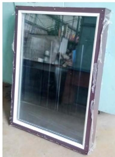
Рис. 3. Внешний вид воздушного солнечного коллектора:
