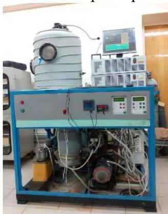
Рис. 1. Технологическая установка магнетронного распыления УМР-71
