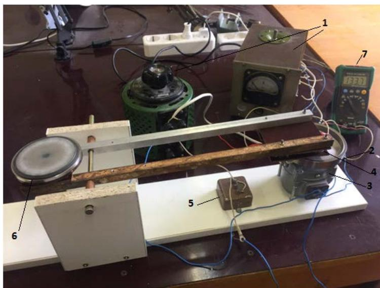
**Рис. 3.** Стенд для контроля износа рабочих поверхностей:
